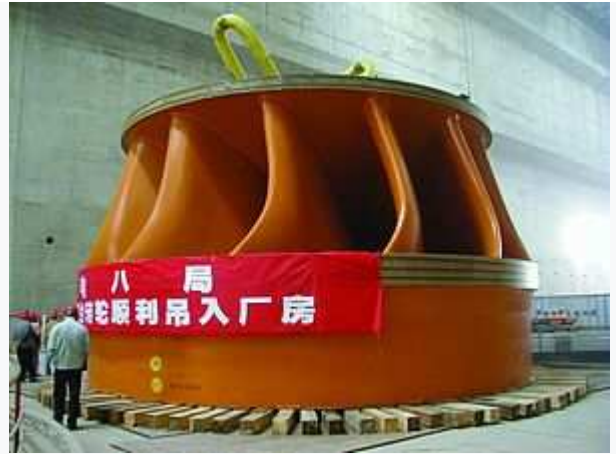
三峡ダム発電所のフランシス水車。
