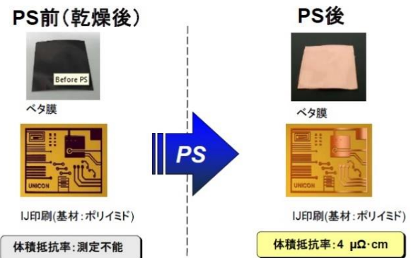
図 1 フォトシタリング前後の Cu 被膜
