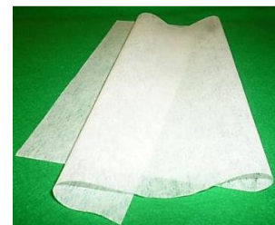
図1：シリカキセロゲル複合断熱材 NASBIS®
